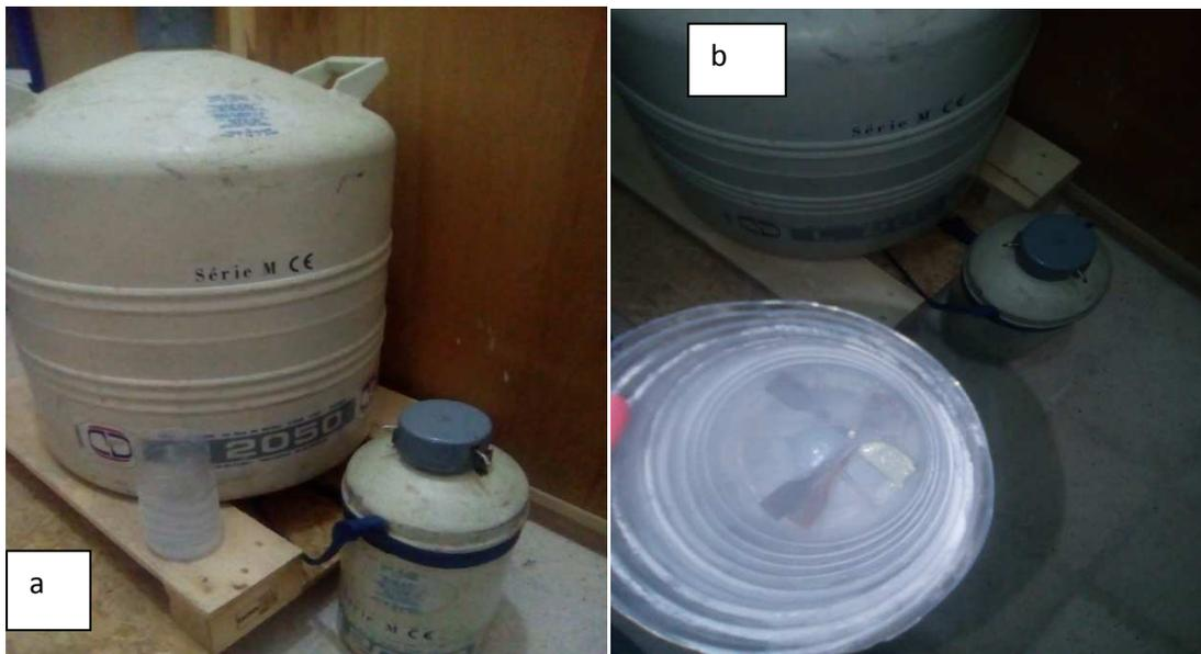
**Figure 45:** a- Bouteille de l'azote liquide, b- Eprouvettes immergées dans de l'azote liquide.
