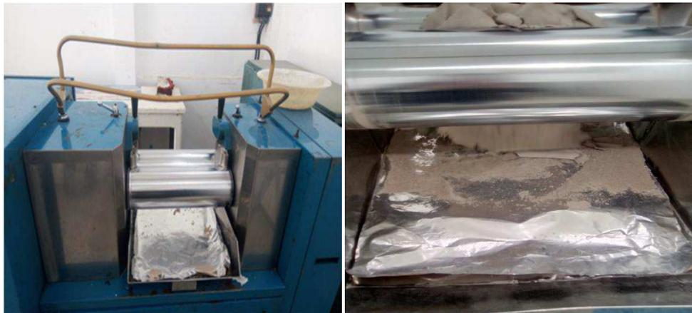
**Figure 27:** Le mélangeur à deux cylindres de SCUYER de type A 80
