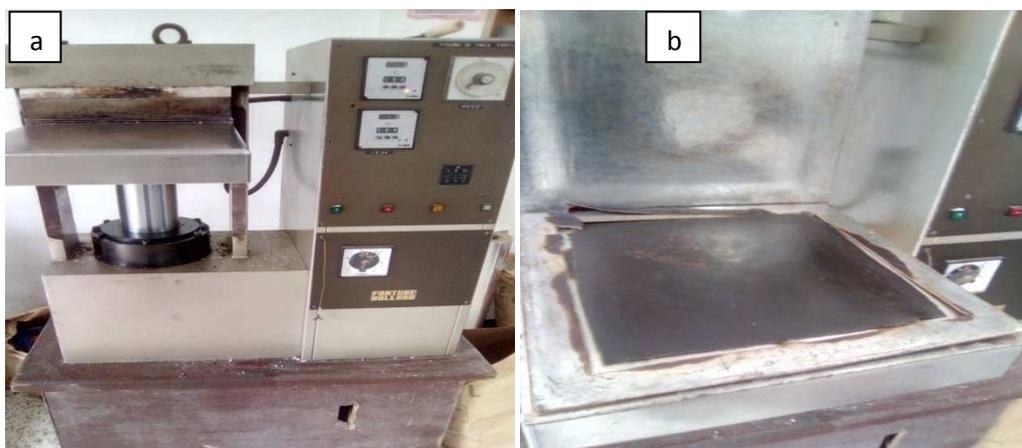
**Figure 28:** (a)- Presse de marque FONTJINE DE MODELE TP 400, (b)- L'obtention de la plaque (Originale, 2018)
