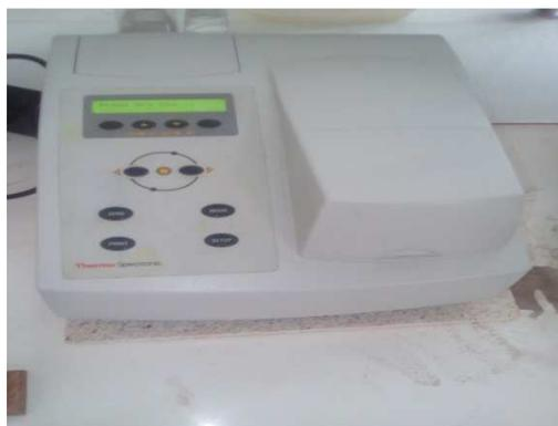
**Figure 38:** Spectrophotomètre à UV.
