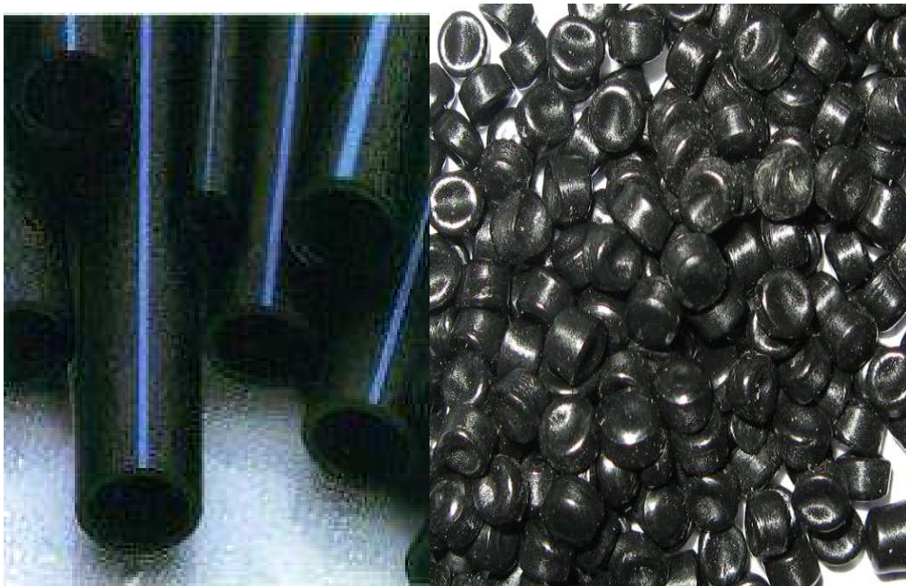
Figure II.1 : Matière première PE sous forme de granulé et tube Pehd [19].
