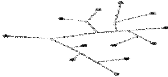
Figure 1-6- Structure en arête de poisson d'un réseau aérien
