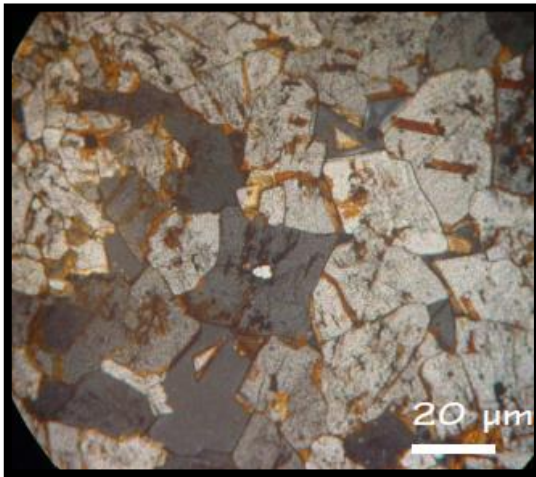
Figure IV.70 : Hématite disposée sur les clivages et les bordures des grains de cristaux de sidérite spathique(Breira). (In Issaad ,2012).
