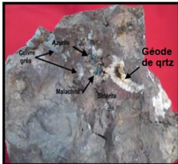
Figure IV.36 : Dissémination de quelques minéraux de Cu gris, Azurite et Malachite) encaissés dans la sidérite massive.
