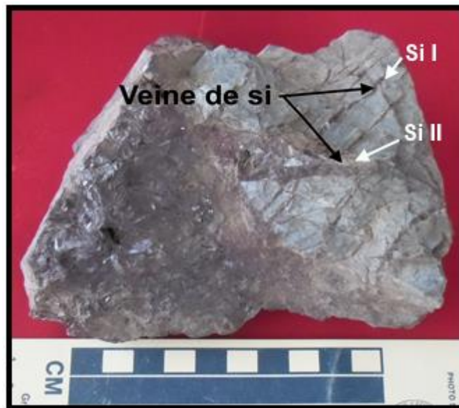
Figure IV.56 : Veinules de sidérite recoupant l'encaissant pélitique (les fours).
