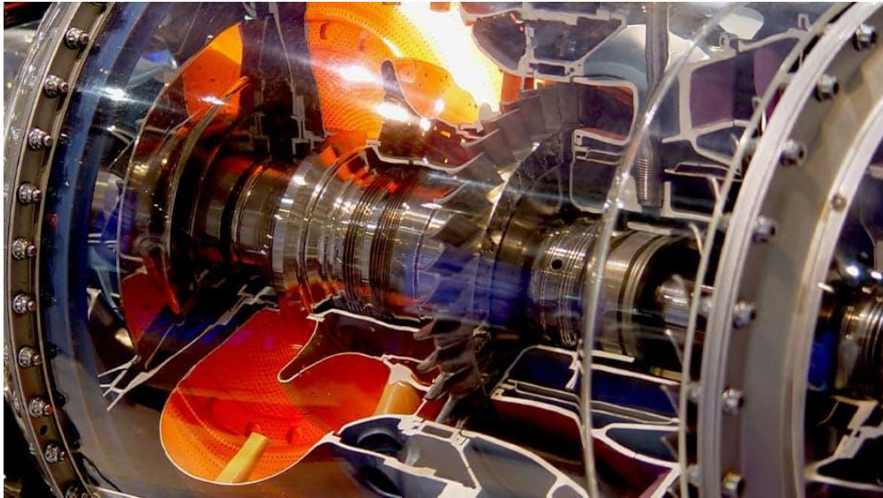
Figure I.2 : La chambre de combustion [5]
