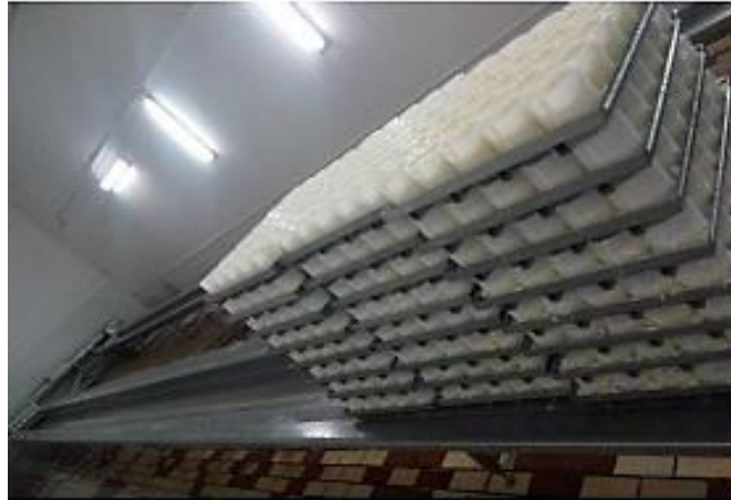
Figure 10 : ressuyage du camembert.
