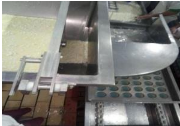
Figure 9 : Moulage et égouttage de caillé du camembert.
