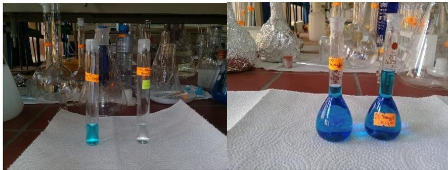
**Figure 2.** Couleur de bleu de méthylène avant et après adsorption pour faible et forte concentration.
