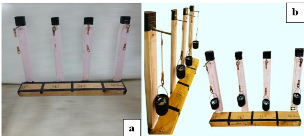
Figure IV- 5:Essai de fluage (a)dispositif l'essai (b) montage expérimentale Application de la charge constante.
