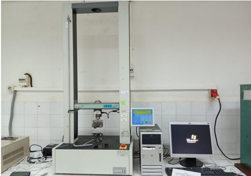
Figure IV- 11: Machine de traction LOYD LR5K Plus utilisée au CNTC de Boumerdès.
