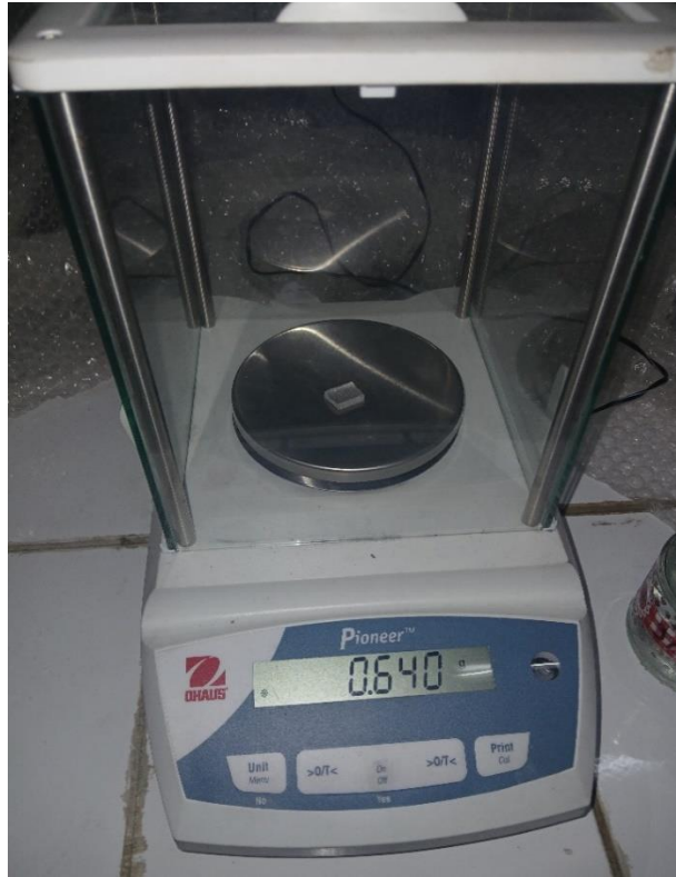
Figure IV- 12: Pesée d'un échantillon de PDMS après immersion
