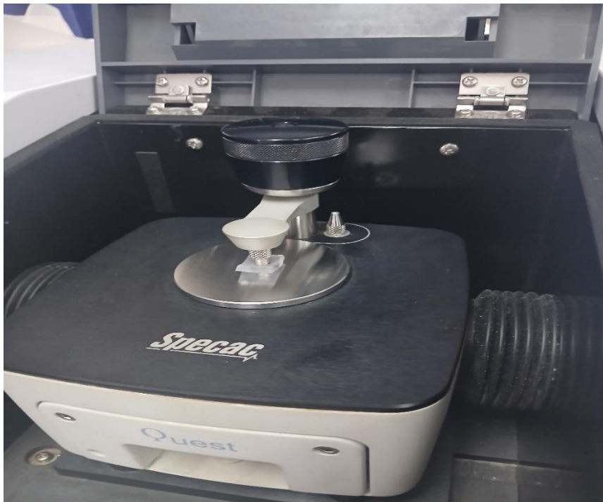
Figure IV- 8: L'échantillon dans Accessoire ATR
