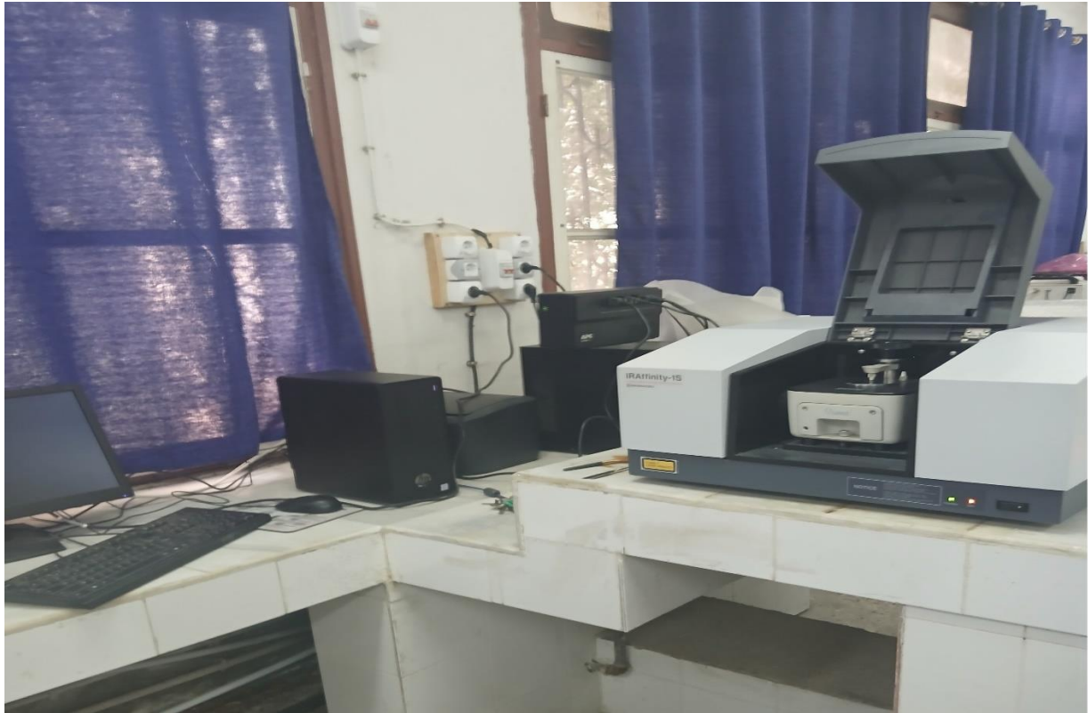
Figure IV- 7: Spectromètre FTIR de laboratoire de chimie (UMMTO)
