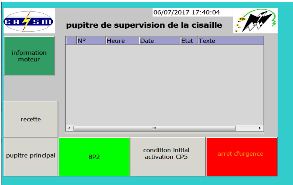
Figure II.13 écran de supervision du tapi roulant
