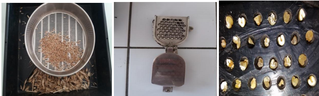
a) Élimination des impuretés b) Farinotome de Pohl c) Aspect de grains mitadinés
