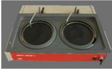
Figure IV.10: Polisseuse à deux disques utilisée pour le dégrossissage
