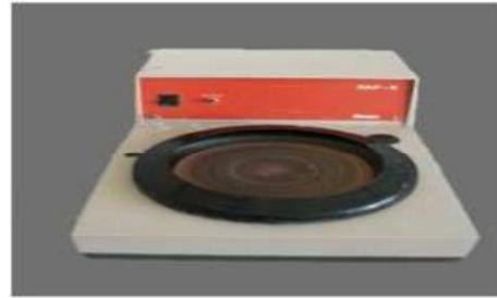
Figure IV.11: Polisseuse à un disque utilisée pour la finition.
