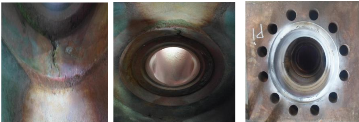
Figure IV.1: Le corps de pompe endommagé .
