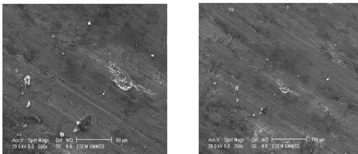
Figure V.24. : Observation MEB de l'échantillon en acier 35 CD4 à l'état trempé
