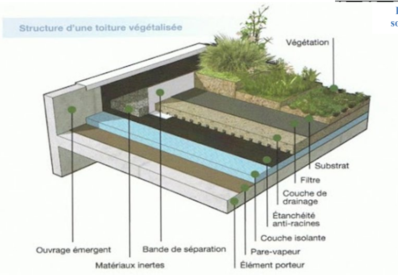
Figure 177 : structure d'une toiture végétalisée source : www.vcare-espacevert.com
