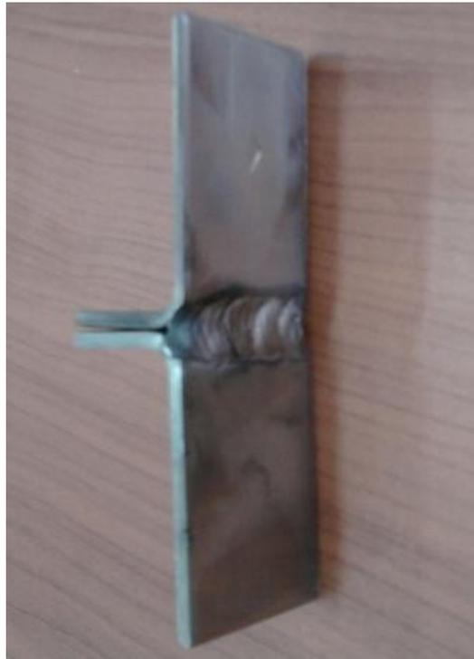
*Fig. III.4 : éprouvette soudée en double L pour traction.*
