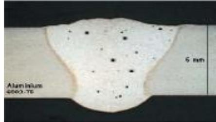
Figure II.19 : Macrographie d'alliage d'aluminium avec présence de soufflures sphéroïdales non débouchantes (zalt)
