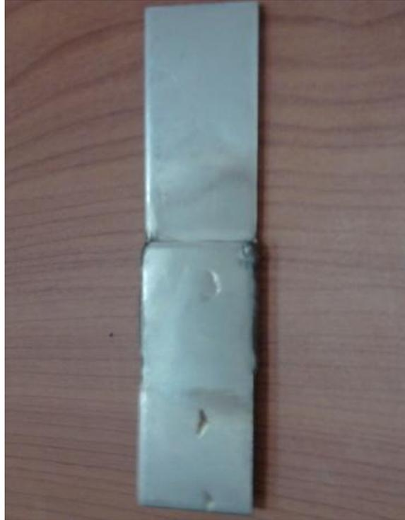
*Fig. III.3 : éprouvette soudée pour cisaillement.*
