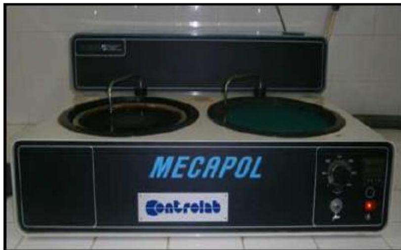
*Fig. III.6 : Polisseuse à deux disques.*
