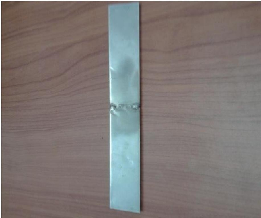
*Fig. III.2 : éprouvette soudée bout à bout pour traction.*
