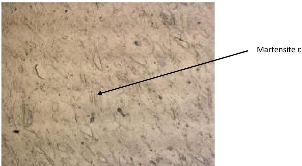
Fig. V.9 : Micrographie optique de l'acier Inox X2CrNi18-9 après déformation.
