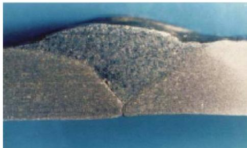
Figure II.21 : manque de pénétration et collage en bord du joint. (zalt)
