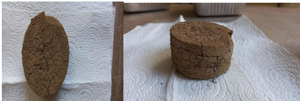
Figure V.28 : Echantillon Sidi Naamane après 4 ème cycle.
