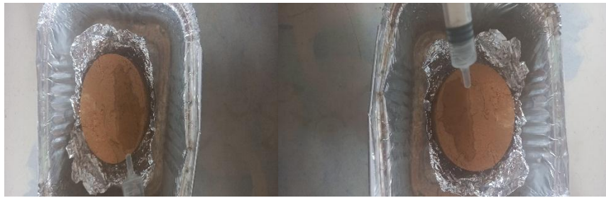
Figure V.3 : Mouillage des échantillons à l'aide d'une seringue.
