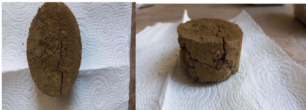
Figure V.26 : Echantillon Azeffoun après 4 ème cycle.
