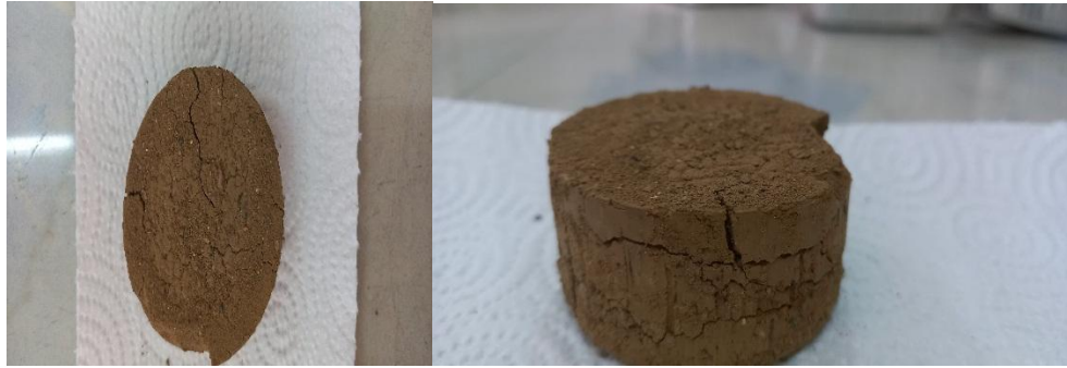
Figure V.23 : Echantillon Sidi Naamane après 3 ème cycle.
