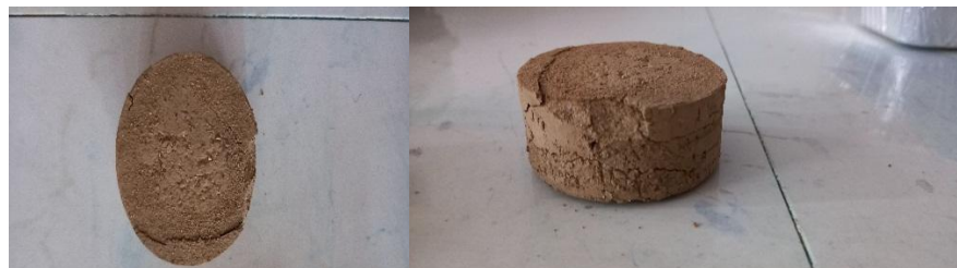
Figure V.18 : Echantillon Sidi Naamane après 2 ème cycle.
