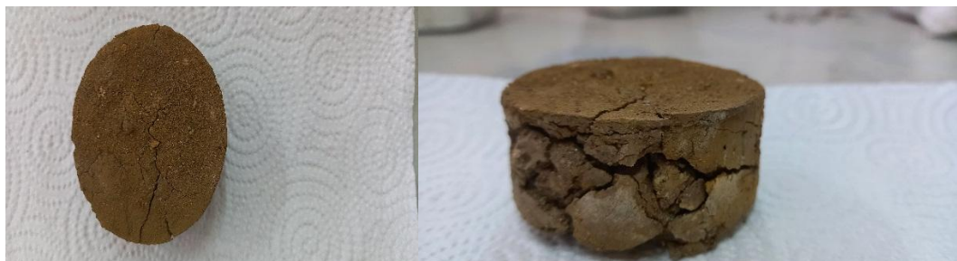
Figure V.21 : Echantillon Azeffoun après 3 ème cycle.
