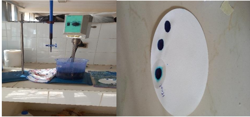
Figure IV.6 : Matériel d'essai au bleu de méthylène (résultats de l'essai à la tâche).
