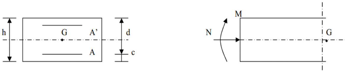
Figure III-2-3 : Section rectangulaire soumise à la flexion composée.
