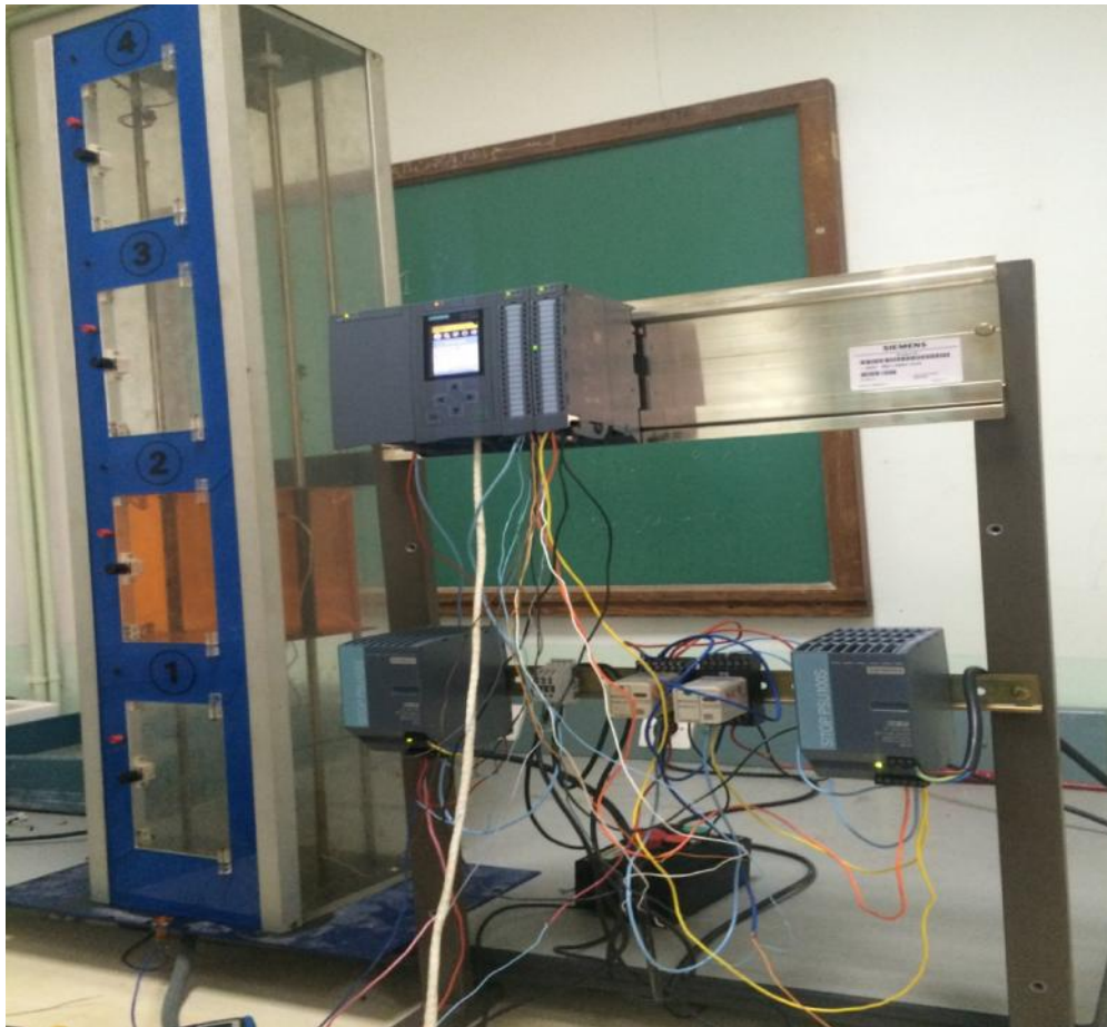
Figure 4.2 : Câblage de l'ascenseur.
