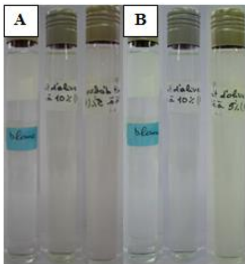
Figure 19: Les mélanges réactionnels pour le dosage des flavonoïdes avant ( A ) et après ( B ) incubation.
