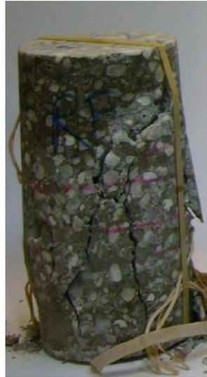
*Fig I.6. Rupture d'une éprouvette de béton après un essai de compression simple [24]*
