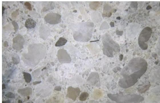
*Fig. I.1. Phases constituant la structure de béton [1]*
