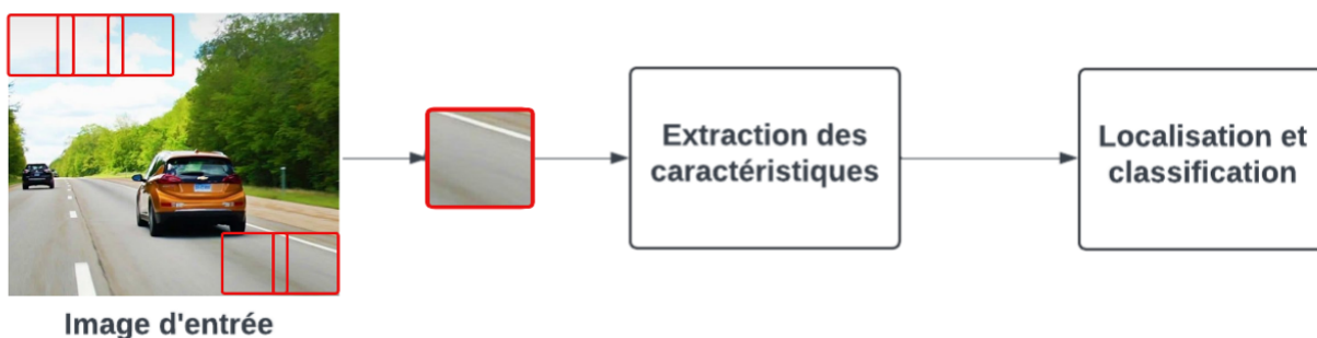
FIGURE 3.3 – Principe de la fenêtre glissante
