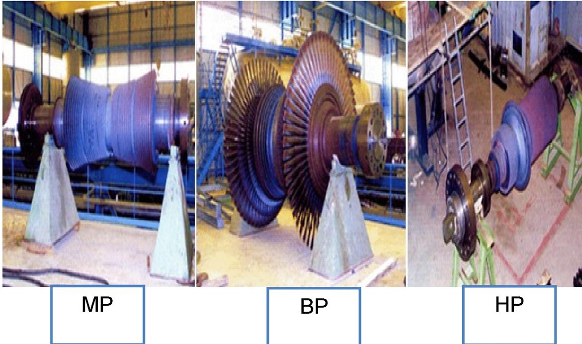
**Figure II.4 :** Les trois corps de la turbine HP, MP, BP.
