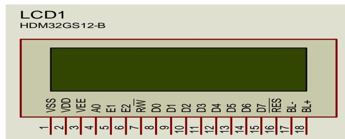
Figure 12 Représentation de l'afficheur LCD
