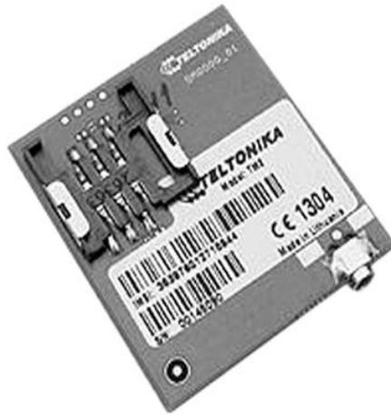
Figure 9 Le module TM2 vu de dessus
