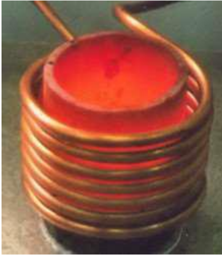
Figure 4: Chauffage d'un métal par induction
