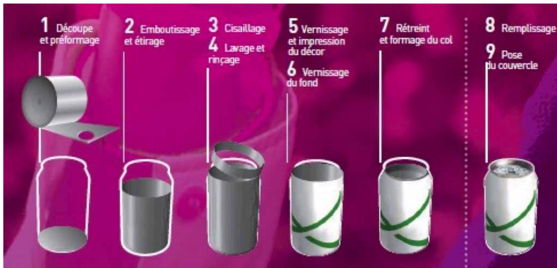
Figure 2: les étapes de fabrication d'une canette en aluminium [13]
