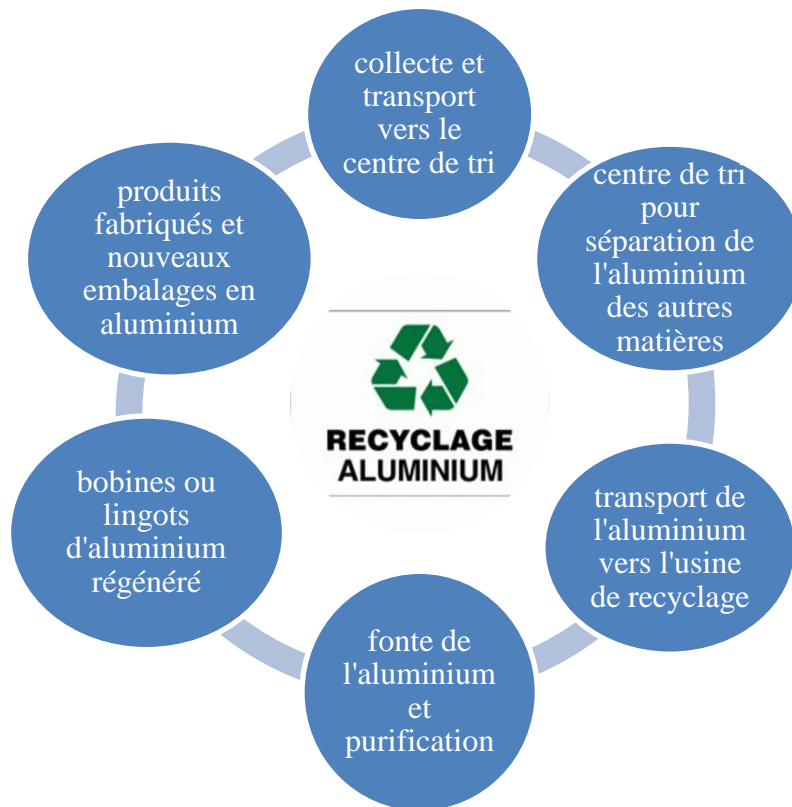
Figure 3: le cycle de vie de l'aluminium recyclé.
