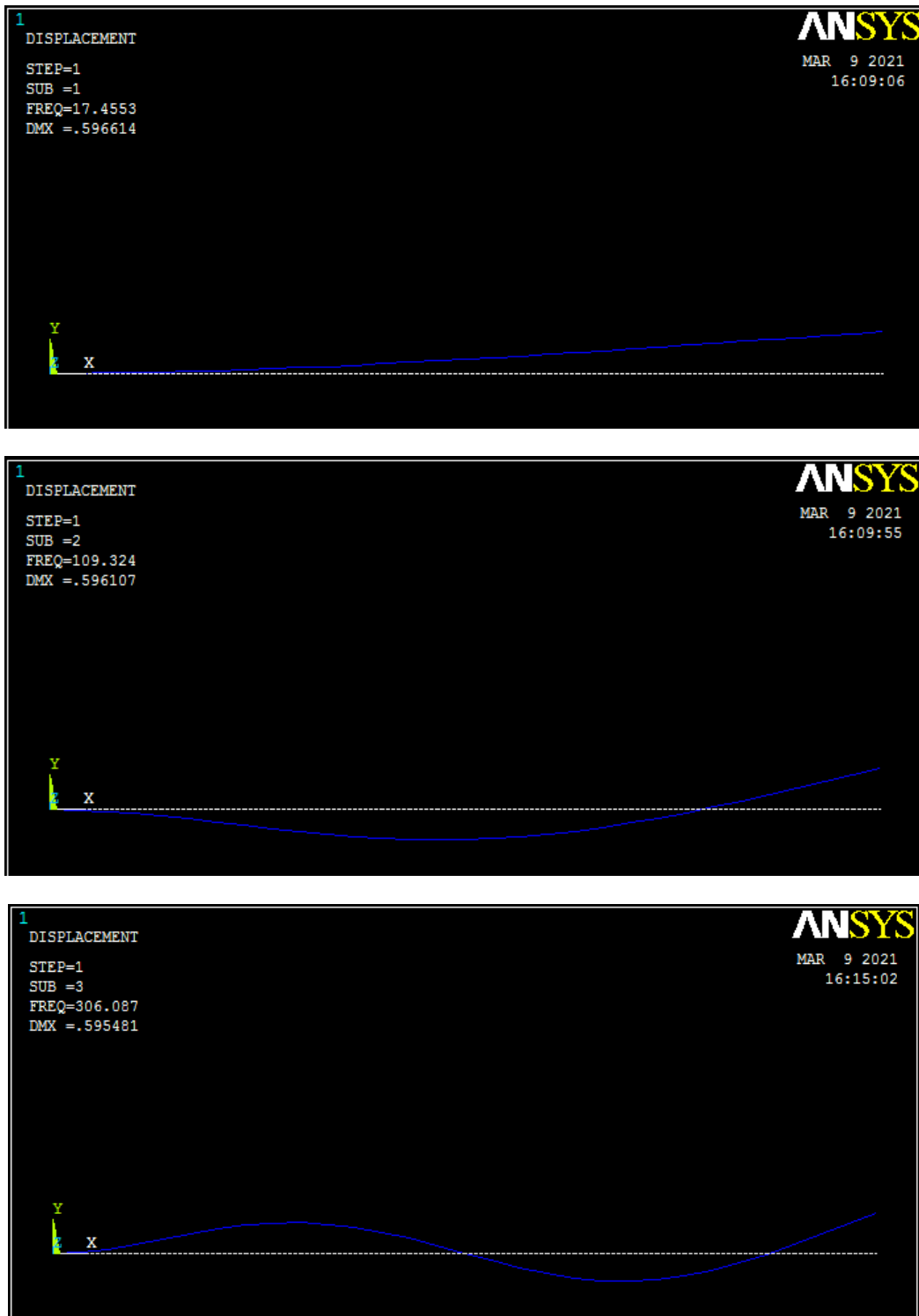
Figure.III.10.Les 3 premiers modes propres obtenus par ANSYS
