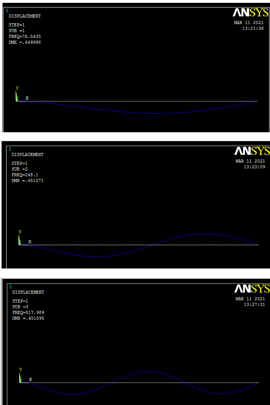
Figure.III.14.Les 3 premiers modes propres obtenus par ANSYS
