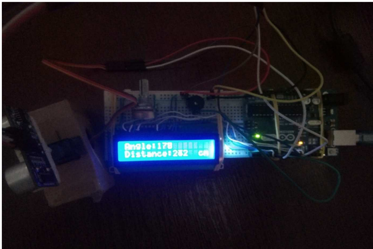
Figure 3.12. Circuit final de notre projet de réalisation du Radar de détection.
