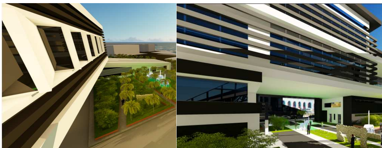
Figure 108: les brises soleil orienté au sud Source : les auteurs.
