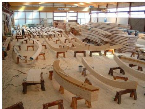
**Figure 116:** photo des poutres en bois lamellé collé
