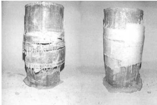
**FigII.9.** Mode de rupture des cylindres enveloppés avec fibres de verre
