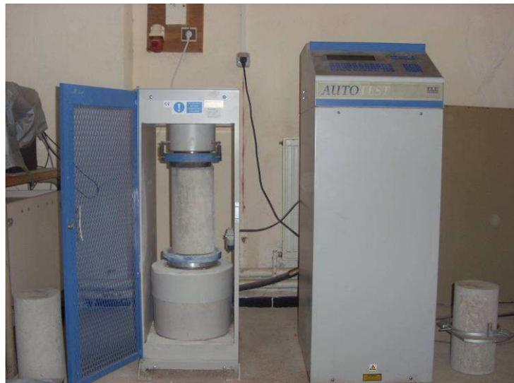
**Fig. III.7 :** *Essais de compression*
