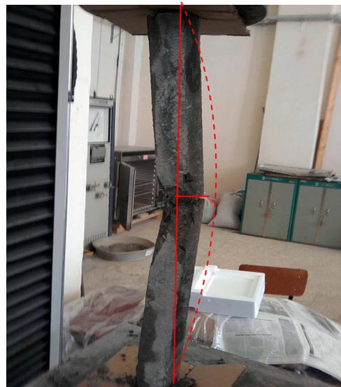
**Figure III.9 :** Exemple de flambement d'une éprouvette soumise à un essai de compression axiale
