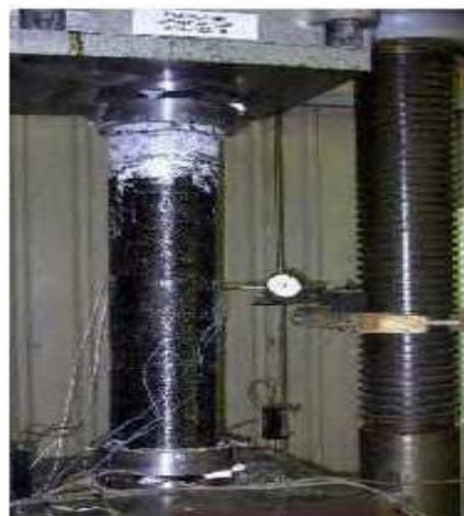
**Fig. II.20** : L'installation expérimentale de colonne confinée par CFRP avec une charge concentrique (Hadi, 2006) [29].
