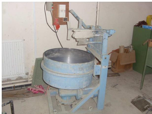
**Fig. III.3** : Malaxeur à axe vertical de capacité 65l
