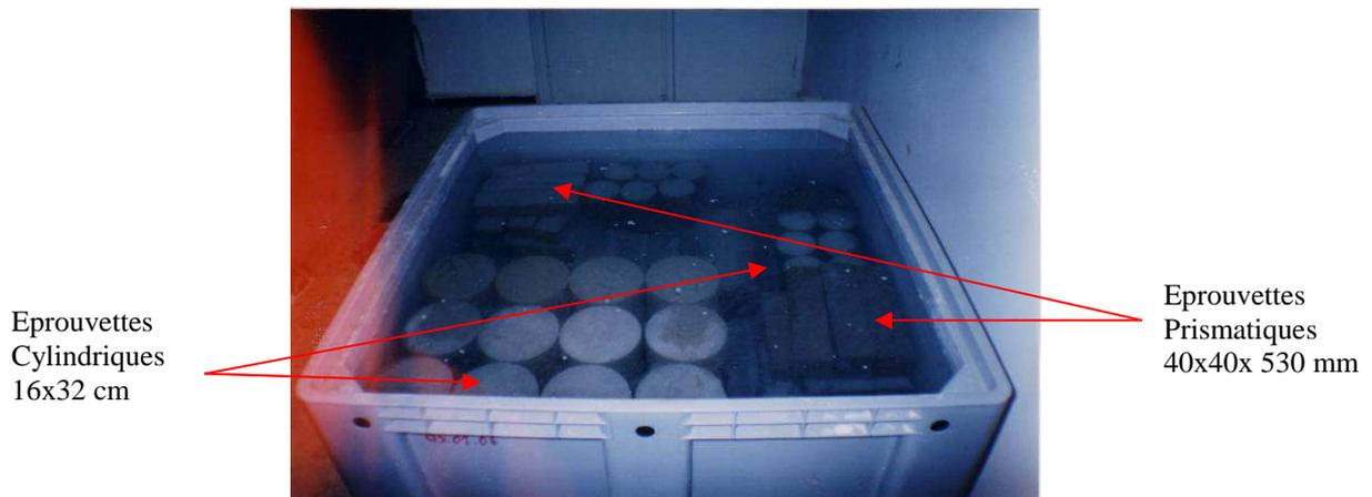
**Fig. III.6 :** Bac de conservation des éprouvettes cylindriques
