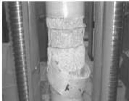
*Fig. II.19 : Rupture de colonne partiellement enveloppée (Mathys et autres, 2005) [28].*
