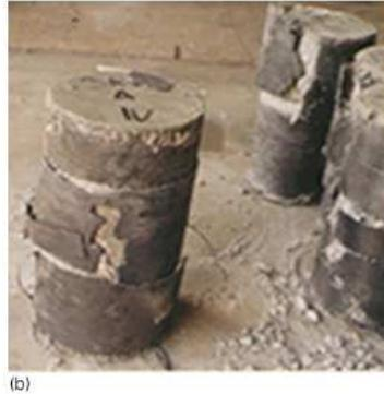
**Fig. II.7 :** (a) instrumentation ; et (b) mode de rupture des spécimens de béton enveloppés par des fibres de carbone [22].
