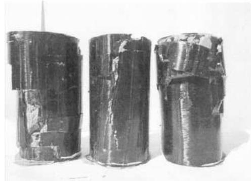
**Fig II.10.** Mode de rupture des cylindres enveloppés avec fibres de carbone
