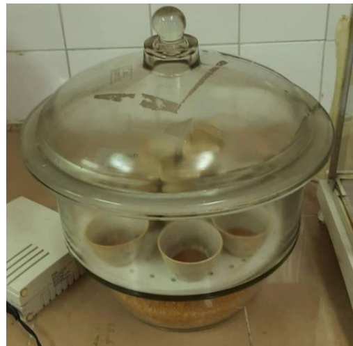
4. Mise dans un dicicateur après sortie du four
