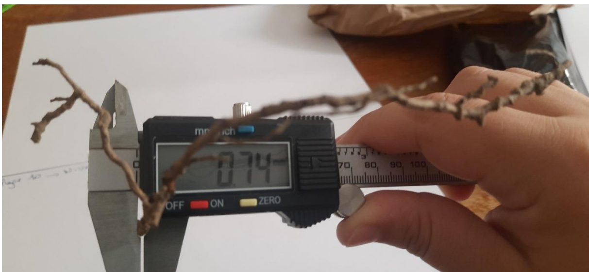
Figure 23 : Mesure du diamètre des racines avec un pied à coulisse électronique
