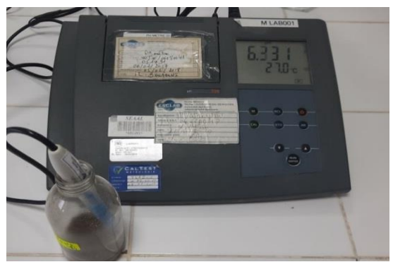
4. Mesure du pH avec un pH mètre
