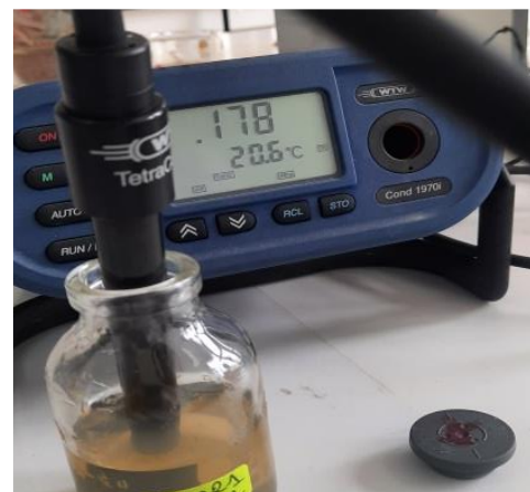
4. Mesure de la conductivité avec un conductimètre
