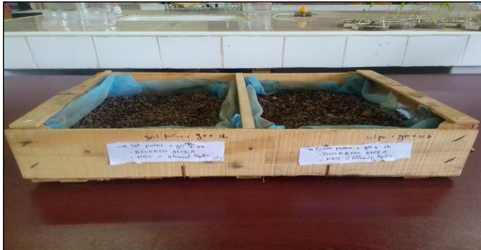
Figure 7. Mini-composteurs du sol pollué aux hydrocarbures.
