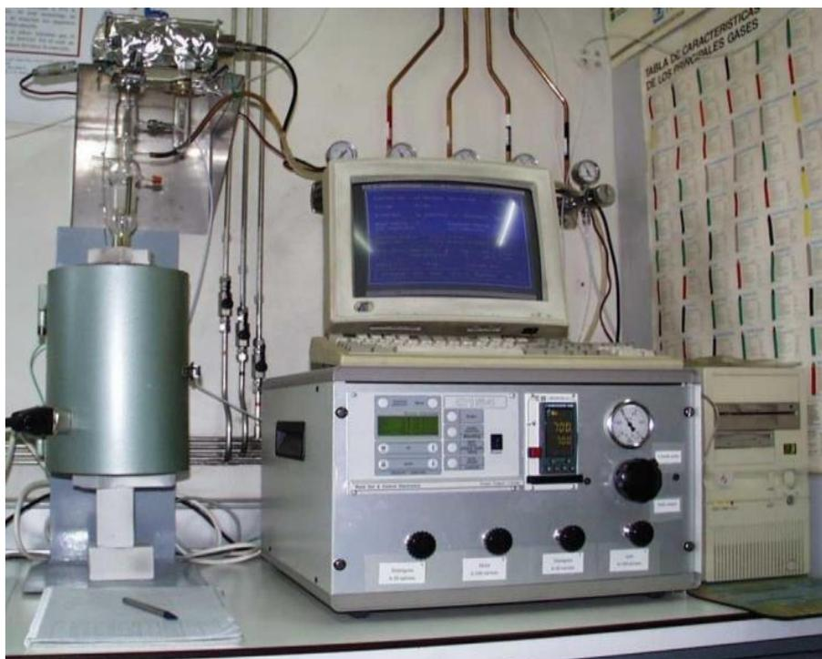
**Figure II.9** : Schéma du montage d'analyse thermogravimétrique (ATG)
