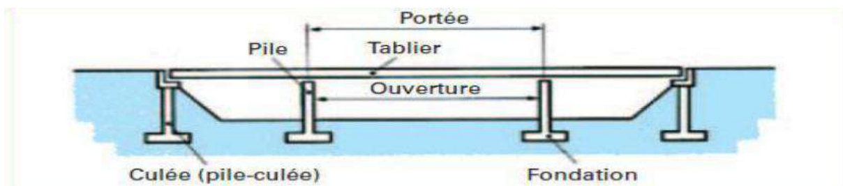
Figure I. 1: Les éléments d'un pont.
