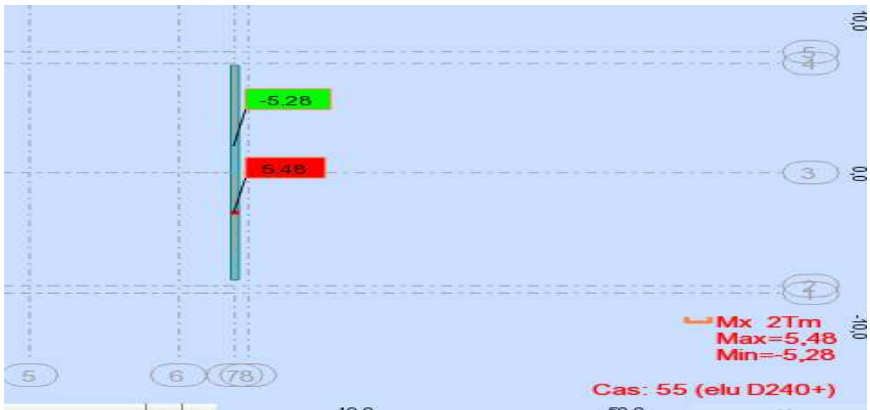
Figures VII. 9 : Moment maximum longitudinale dans la poutre (entretoise).
