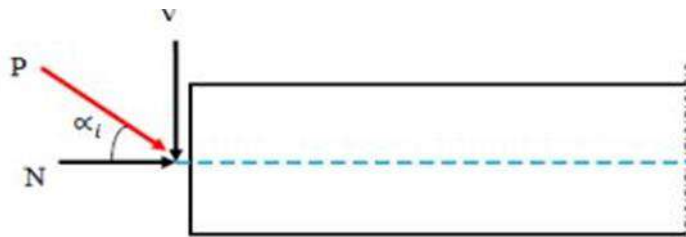
Figures VIII. 4 : Composante de la force de la précontrainte.
