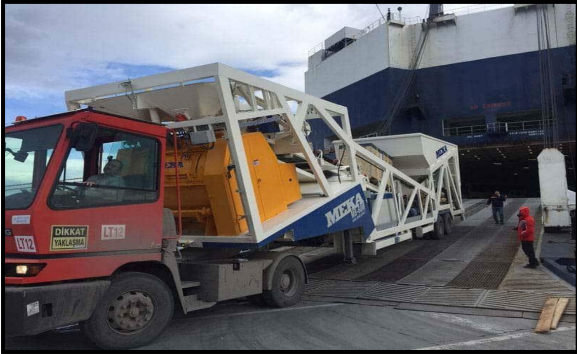
Figure I.5: Centrale à béton mobile
