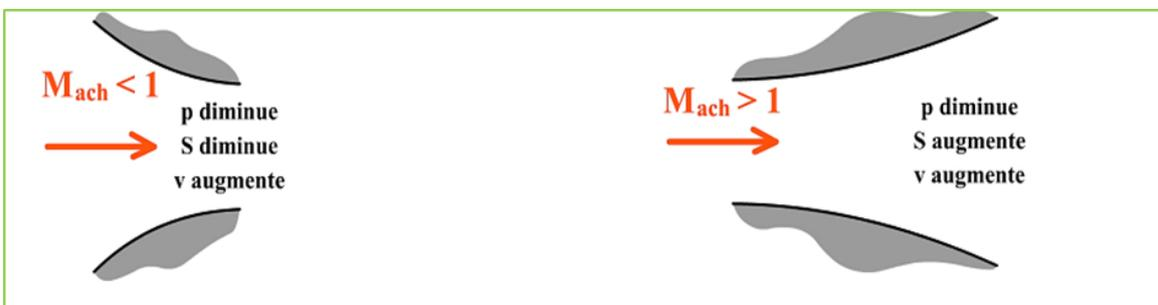
Figure (II.5) : Ecoulement dans une tuyère convergente divergente
