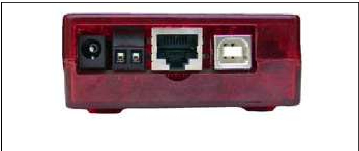
Fig.III.2 : coté bas de labjack UE9.
