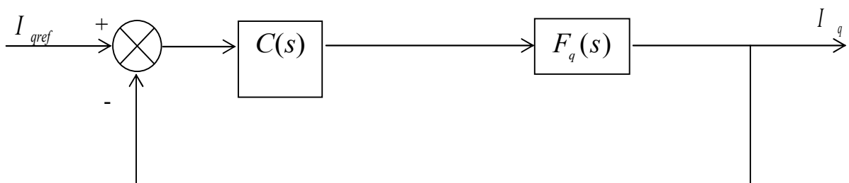
Figure (III.12) : Boucle de régulation du courant i_q
