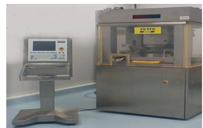
Figure 4 : Presse à comprimés FETTE 2200i
