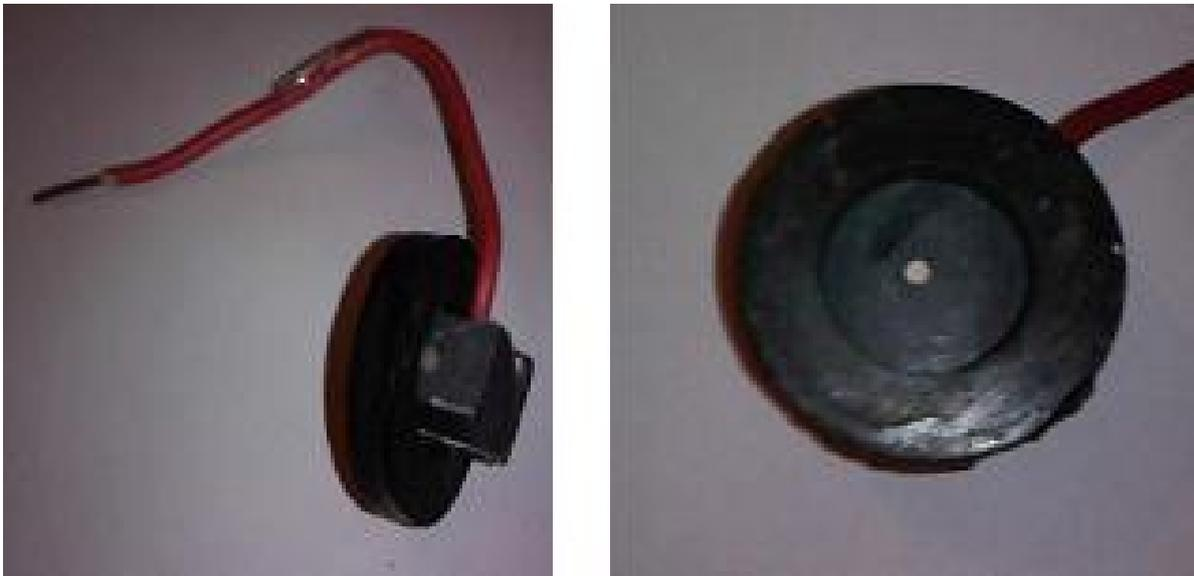
**Figure V.3 :** a) aimant positioné perpendiculairement à la section du fil, b) aimant positioné parallèlement à la section du fil.
