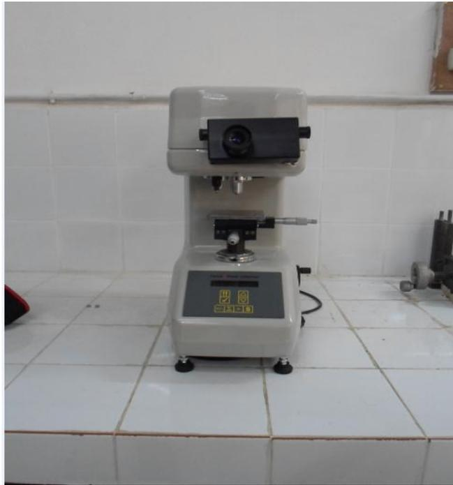
**Figure V.5 :** Microduromètre ZWICKROELZHV1M.
