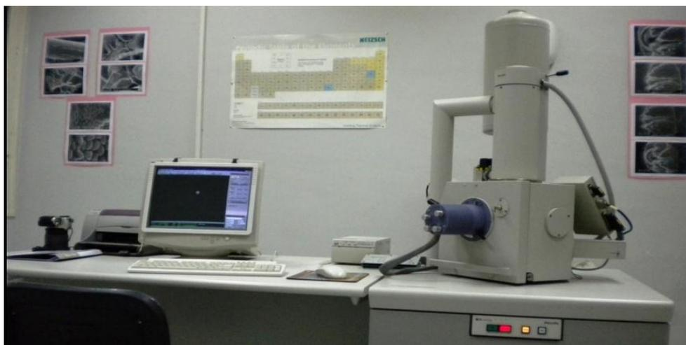
**Figure V.7:** Microscope électronique à balayage (Philips ESEM6XL30SEM).
