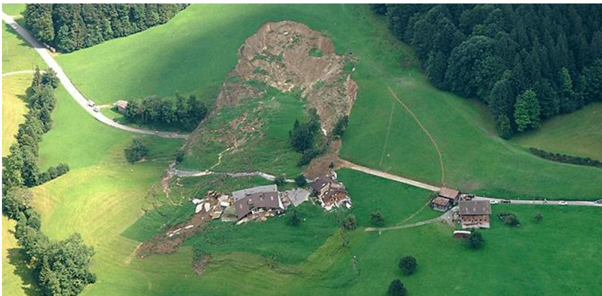
**Figure I. 19:** Exemple d'un glissement profond (suisse).
