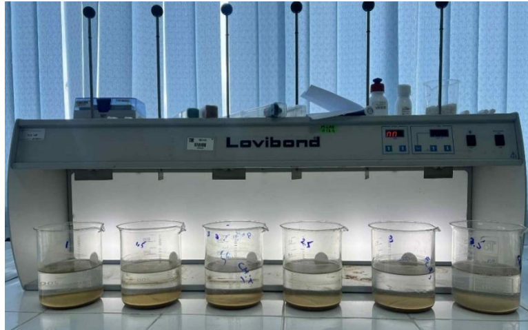
Figure IV.5. Dispositif d'agitation en série de type jar test .
