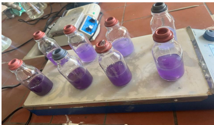
Figure IV.6 : Agitateur magnétique pour les expériences d'adsorption du colorant (BD).
