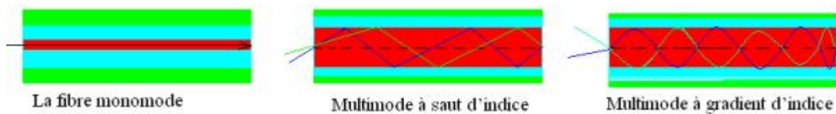
Figure.4. les types de fibre optique
