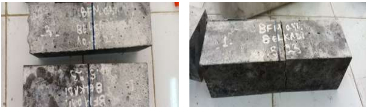
Figure IV.16: Aspect des éprouvettes prismatiques BFA à 20 °C avant et après écrasement.
