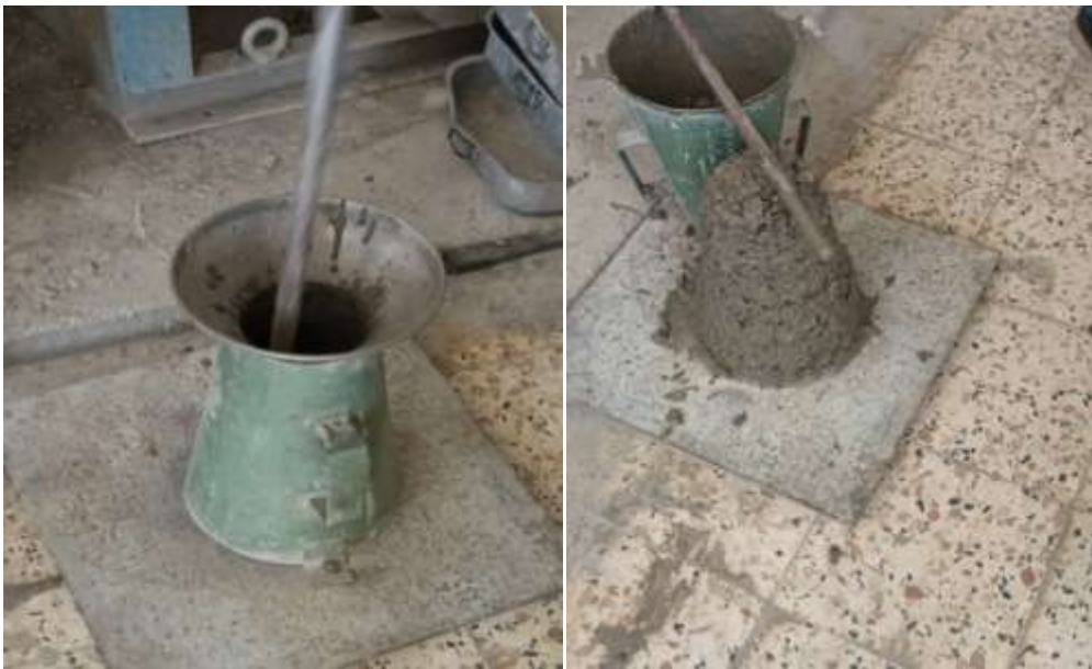
Figure III.15 : Détermination d'affaissement du béton à l'état frais.
