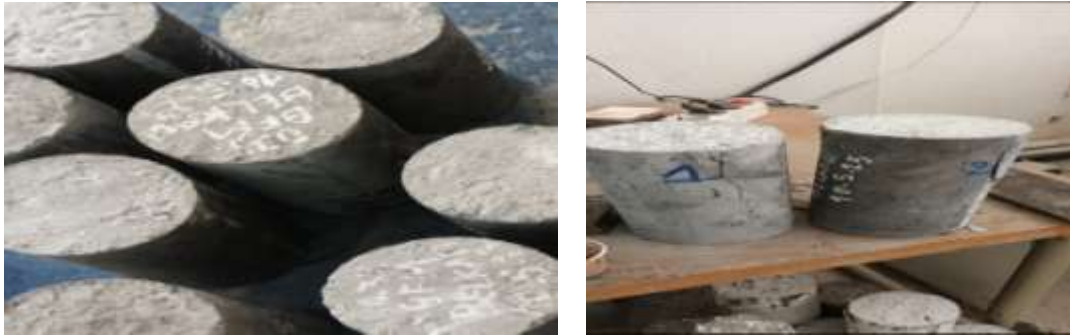
Figure IV.8: Aspect des éprouvettes BFA à 20°C avant et après écrasement.
