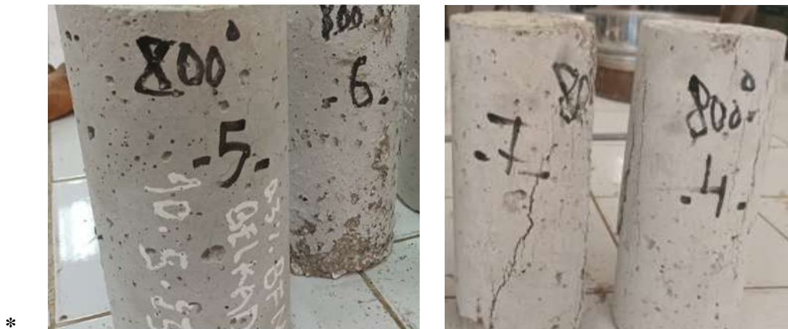
Figure IV.10: Aspect des éprouvettes BFA à 800°C avant et après écrasement.
