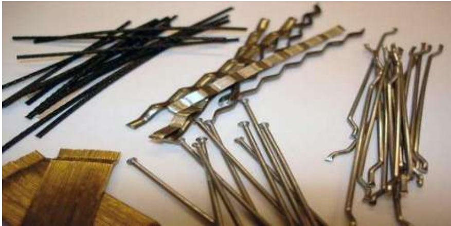
Figure I.15: Différentes formes de fibres [15]
