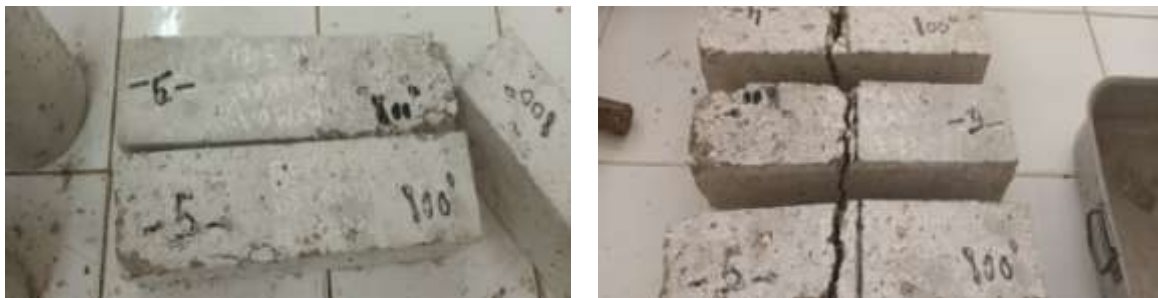
Figure IV.18: Aspect des éprouvettes prismatiques BFA à 800 °C avant et après écrasement.
