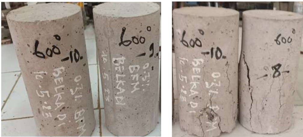
Figure IV.9: Aspect des éprouvettes BFA à 600°C avant et après écrasement.
