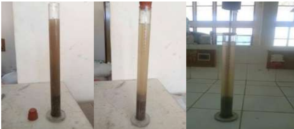
Figure III.10 : Essai de l'équivalent de sable.
