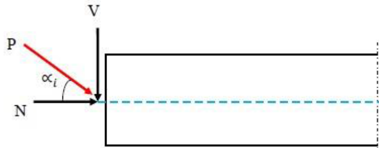
Figure VIII.6: composantes de la force de précontrainte.
