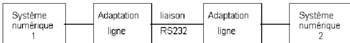
Figure II-16: Schéma fonctionnel d'une liaison série asynchrone de la norme RS232.
