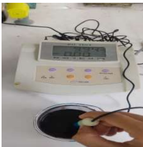
Figure 27 : Mesure du pH des biochars [Origine, 2024]
