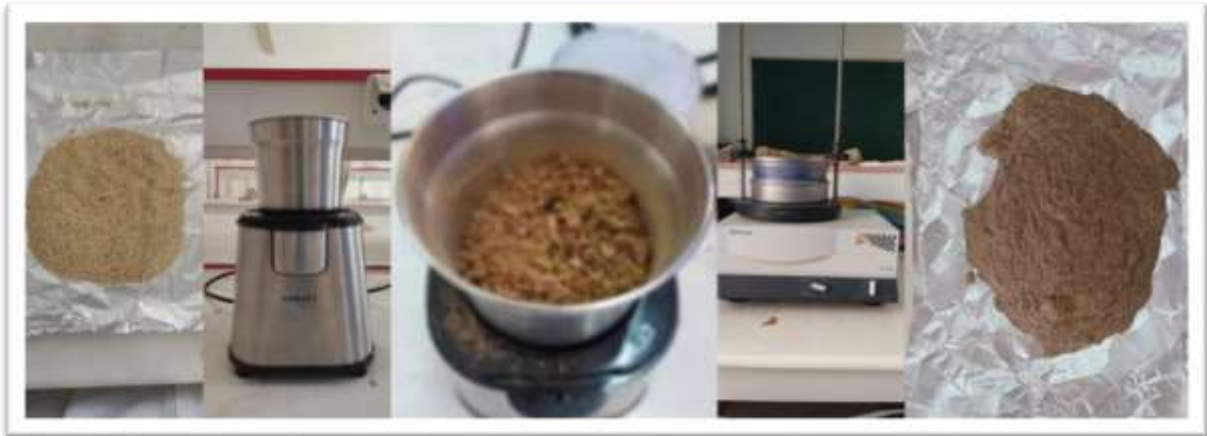
Figure18 : Différentes étapes de préparation des échantillons [Origine,2024]
