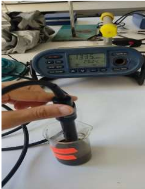
Figure 25 : mesure de la conductivité électrique [Origine,2024]
