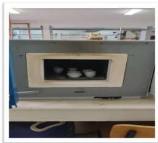
Figure 20 : Emplacement des creusets dans un four à moufle [Origine, 2024]
