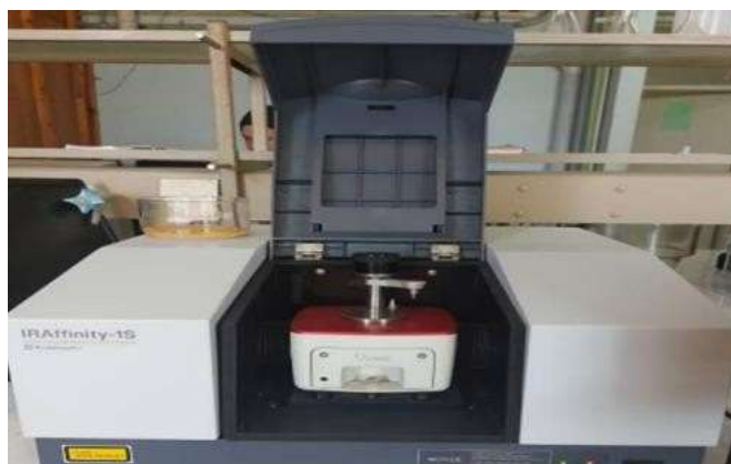
Figure 28 : Spectromètre Proche Infrarouge ; Spectromètre IRAffinity – 1S[Origine,2024]
