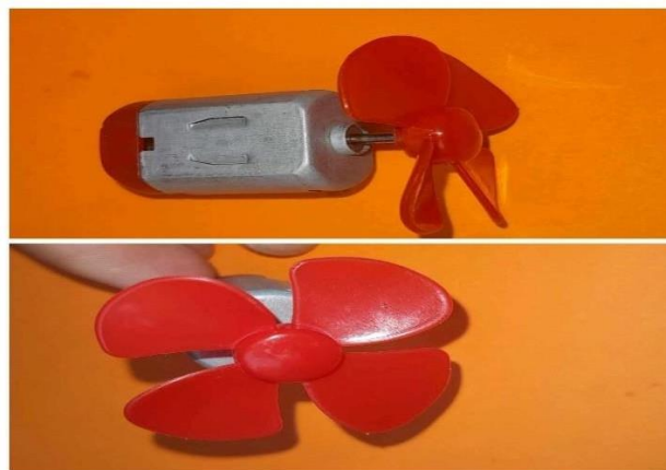
FigureII.20 : Moteur DC entrainant un ventilateur
