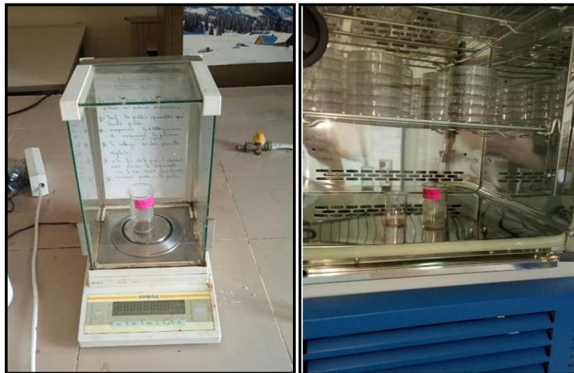
Figure 24. Photo illustrant le matériel utilisé pour la détermination l'humidité hygroscopique (Originelle, 2019)
