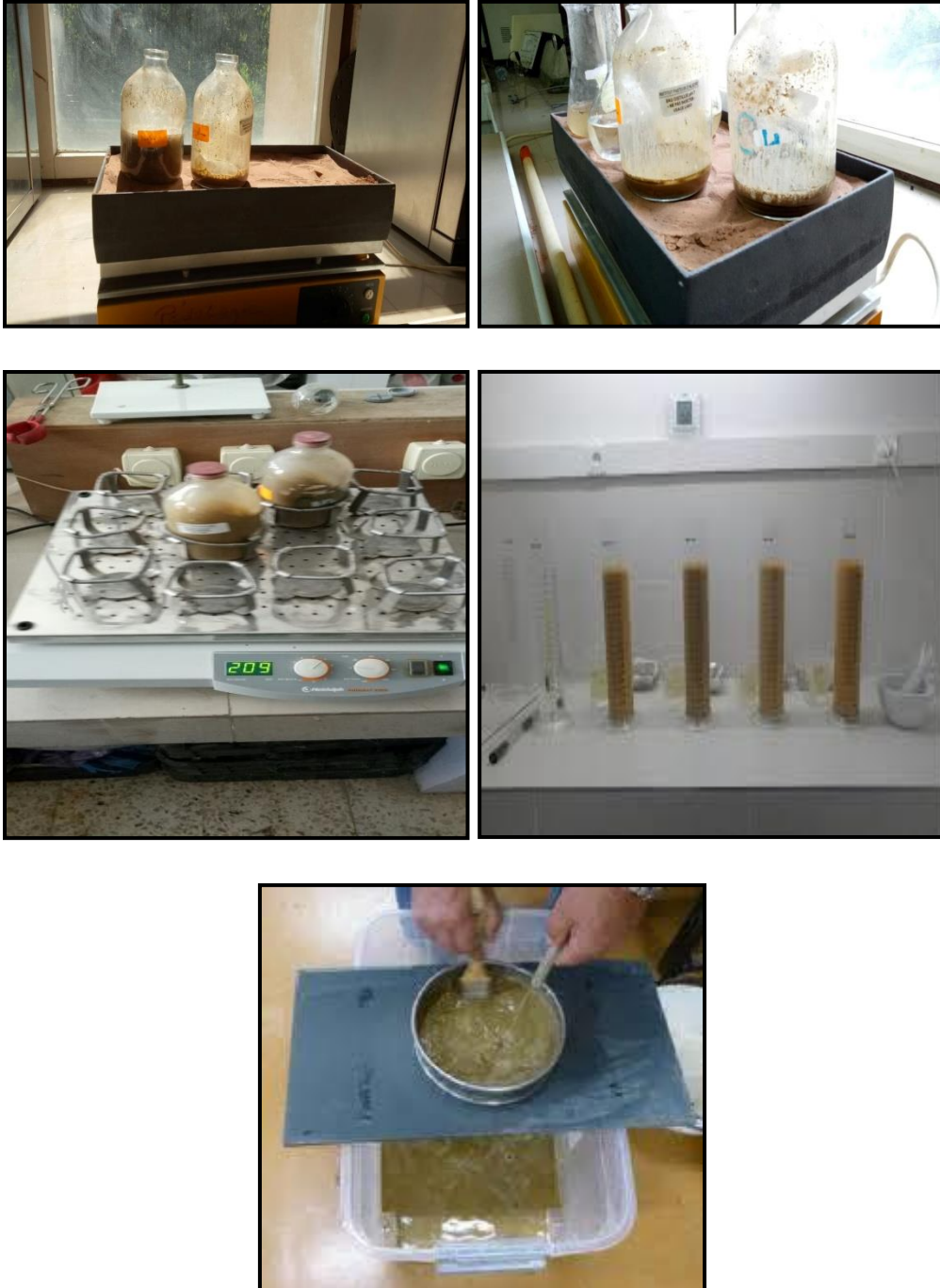
Figure 27. Photos illustrant les différentes phases suivies pour réaliser l'analyse granulométrique
