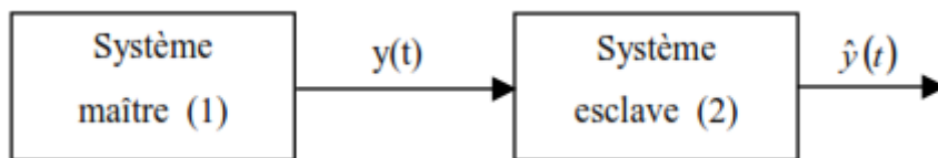
Figure.23 : Système maître-esclave pour réaliser la synchronisation.
