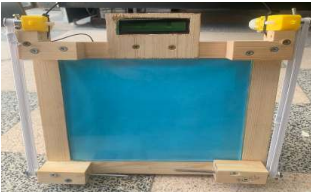
Figure IV. 57 : image du système de nettoyage
