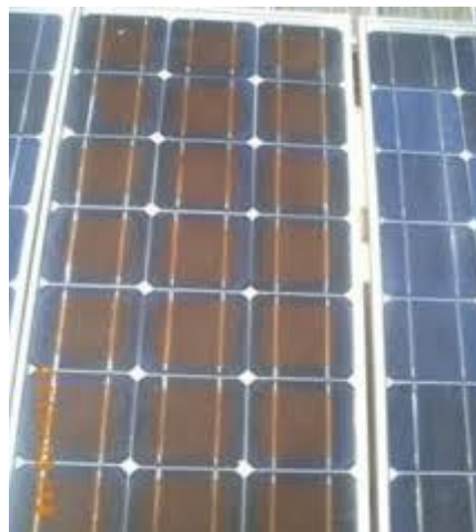
Figure I.20 : panneau photovoltaïque décoloré [16]
