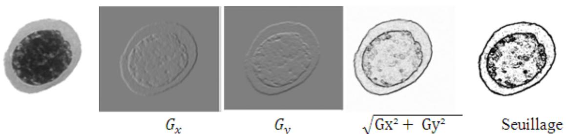
**Figure II.1 :** Extraction des contours à partir du gradient
