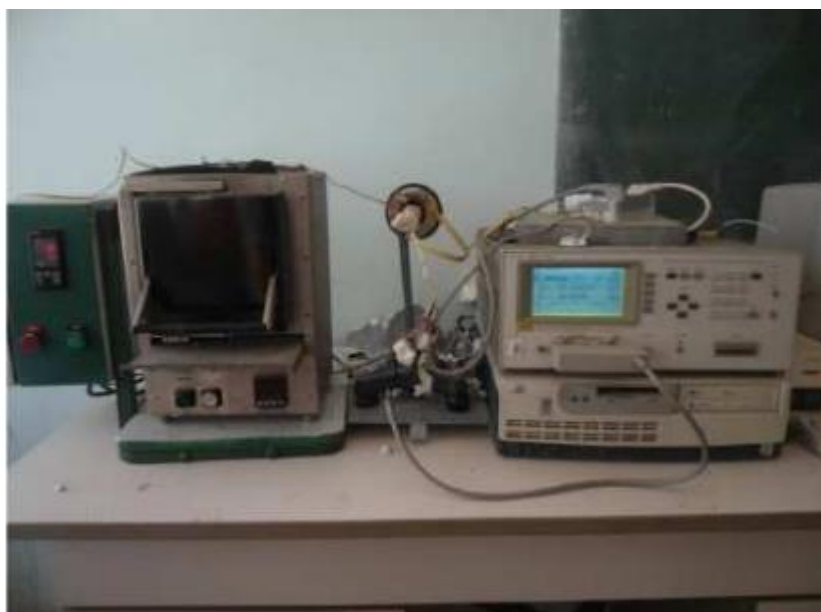
Figure II. 7 : l'appareil de mesure des propriétés diélectriques.
